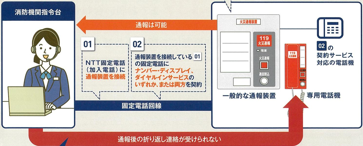
通報装置の通報ボタン押下により、消防機関への通報は問題なく完了。その後、消防機関からの折り返し連絡が入り通報装置の専用電話機が鳴動するが、鳴動後すぐに受話器を取ると通話ができない。
